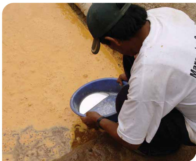
Uso de mercurio para extraer oro por mineros artesanales en Mollehuaca, Perú. Fuente: Ministerio del Ambiente de Perú.
