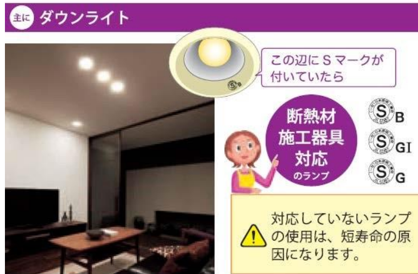
図 7. 断熱材施工器具対応のタイプの例 3
